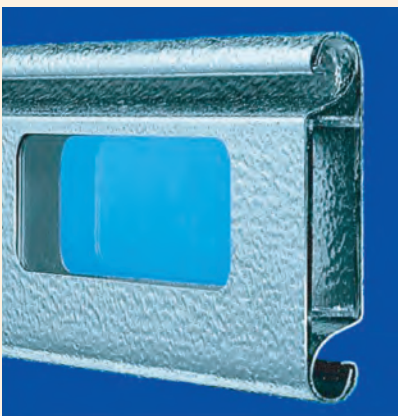
4020 Stucco mit Verglasung Isolierung: Styropor-Füllung Anzahl Stäbe pro Meter höhe: 10 Gewicht pro m 2 : 9,5 kg Dämmwerte: k-Wert: ~4,3 W/m 2 K RW-Wert: ~21 dB
