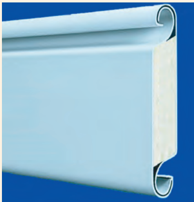
4020 Isolierung: Styropor-Füllung Anzahl Stäbe pro Meter höhe: 10 Gewicht pro m 2 : 9,5 kg Dämmwerte: k-Wert: ~4,3 W/m 2 K RW-Wert: ~21 dB
