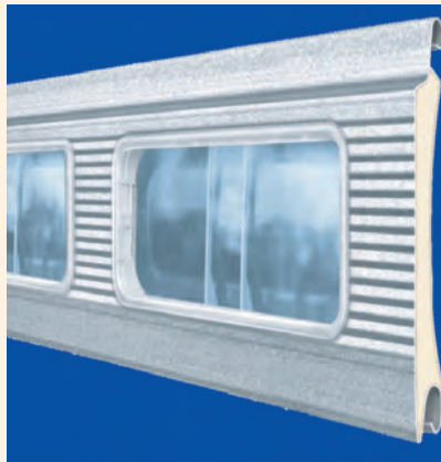
Thermo mit Verglasung Isolierung: PU-geschäumt Anzahl Stäbe pro Meter höhe: 10,7 Gewicht pro m 2 : 10,8 kg Dämmwerte: k-Wert: ~3,5 W/ RW-Wert: ~20 dB
