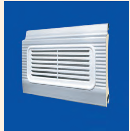
Thermo mit Lüftungsgitter Isolierung: PU-geschäumt Anzahl Stäbe pro Meter höhe: 10,7 Gewicht pro m 2 : 10,8 kg Dämmwerte: k-Wert: ~3,5 W/m 2 K RW-Wert: ~20 dB
