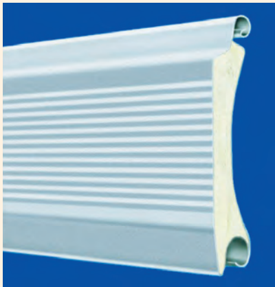
Thermo Isolierung: PU-geschäumt Anzahl Stäbe pro Meter höhe: 10,7 Gewicht pro m 2 : 10,8 kg Dämmwerte: k-Wert: ~3,5 W/m 2 K RW-Wert: ~20 dB
