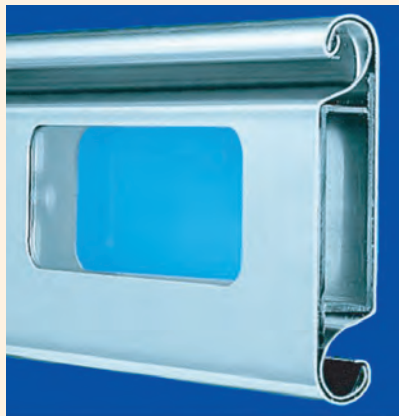
4020 mit Verglasung Isolierung: Styropor-Füllung Anzahl Stäbe pro Meter höhe: 10 Gewicht pro m 2 : 9,5 kg Dämmwerte: k-Wert: ~4,3 W/m 2 K RW-Wert: ~21 dB
